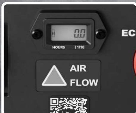
Käyttötuntien laskuri. Näyttö, kun volyyminvirtaus on alitettu.
