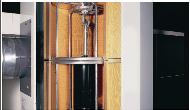
RoboCleanPlus suodattimen automaattinen puhdistusjärjestelmä, puhdistaa lohkoittain suodatinpatruunat paineilmalla
